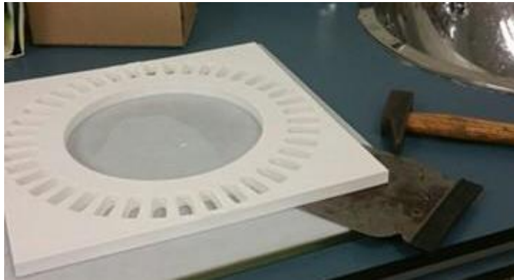
Fig.52: La placa recién impresa. Proceso de despegarla de la base de impresión.
