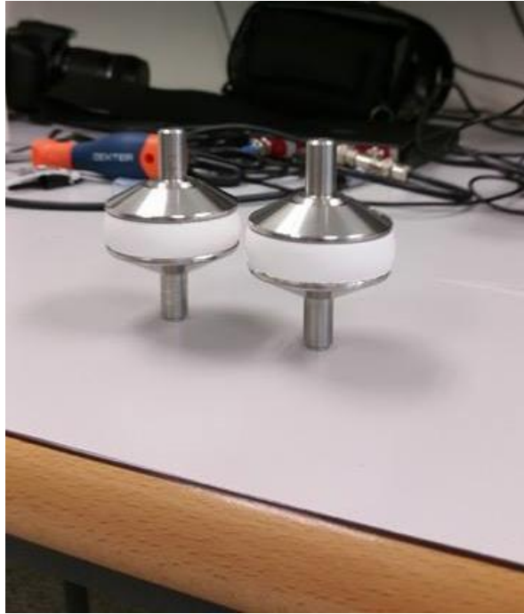
Fig. : Transductores en contacto directo.
