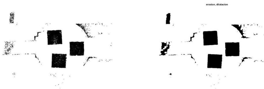
Figura 12. Resultado de la primera serie: erosión, SE=3x3 y 12x12
