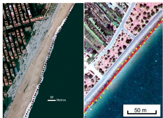
Figura 3. (Izquierda) Posición de la línea de costa obtenida a partir de la imagen Landsat 7 del 14/01/2003 superpuesta sobre una ortofotografía registrada ese mismo día por la tarde. Playa de la Barceloneta, Barcelona. (Derecha) En amarillo la línea de costa obtenida automáticamente partiendo de una imagen Landsat. En rojo, línea de referencia. Costa de Borriana (Castellón).
