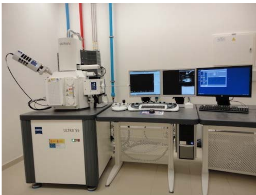
Figura 24: Microscopio electrónico de barrido de emisión de campo (FE-SEM) ZEISS modelo ULTRA55 del Servicio de microscopía electrónica de la UPV.
