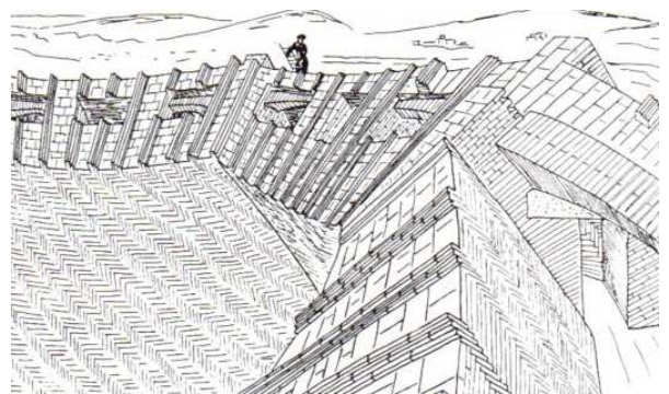
Figuras 137 y 138: Detalles construcción de la cúpula
