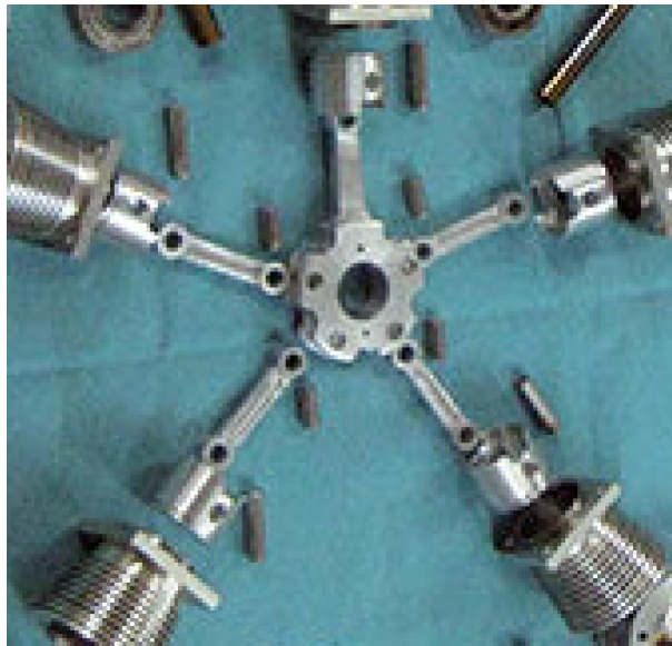
Ilustración 27 – Biela maestra y bieletas de un motor radial de cinco cilindros
