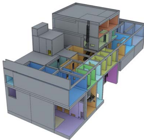
Fig 5. Modelo 3D BIM de un edificio de una central nuclear con sus zonas, Propia, 2017.
