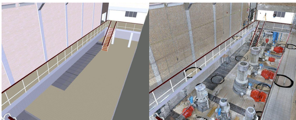
Fig 5. Superposición entre el modelo Revit y el escáner 3D. Infranea bvba. 2016
