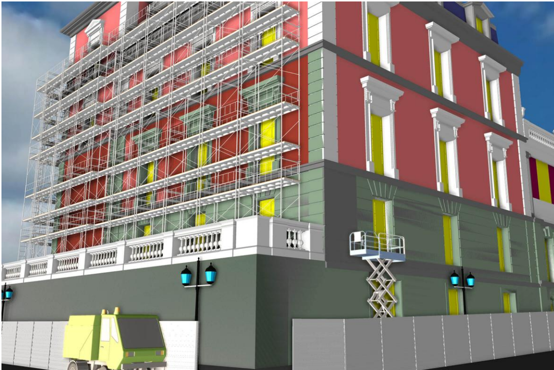
Fig. 2. Vista Suroeste del modelo 3D del Salón de Reinos limpiándose la piedra (durante la rehabilitación). 2016. Fuente propia.
