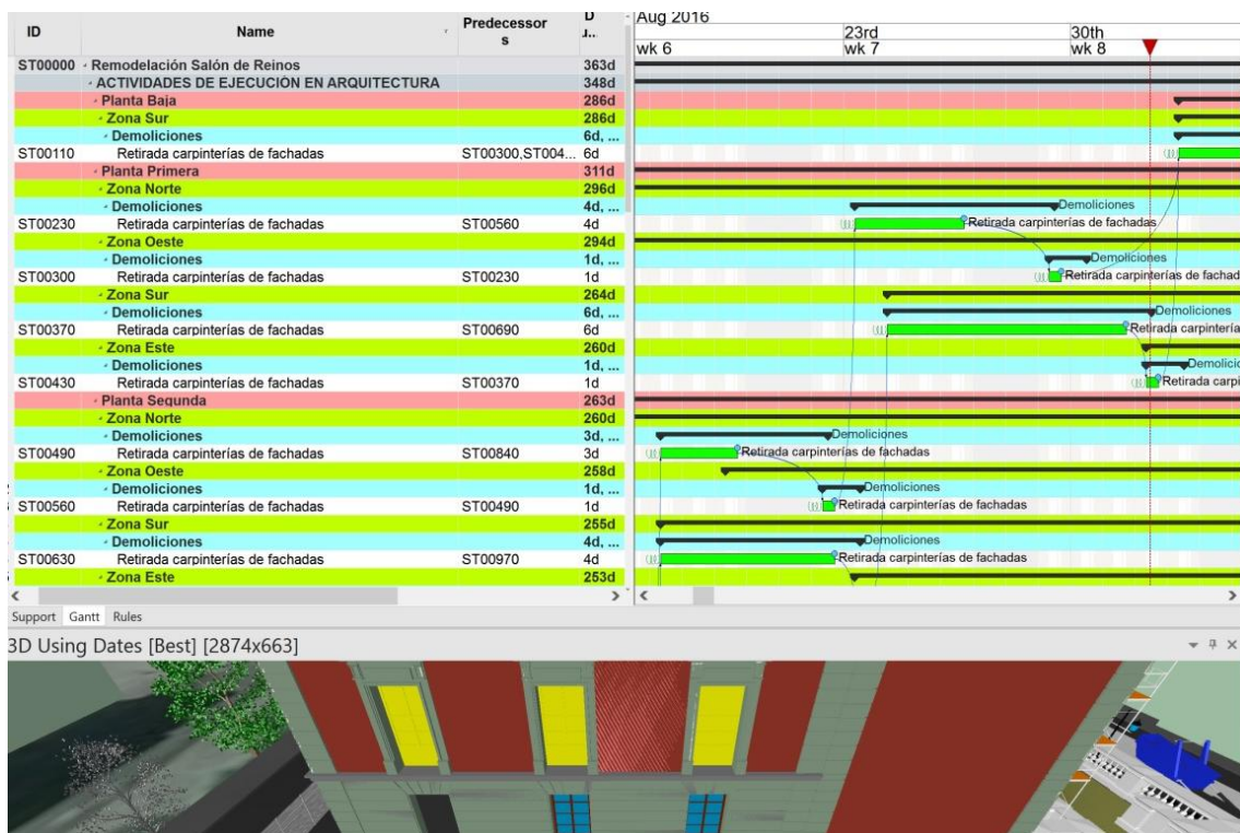
Fig. 3. Tabla de días aplicables a la tarea de “Retirada de carpinterías de fachadas” según planta y zona. 2016. Fuente propia.
