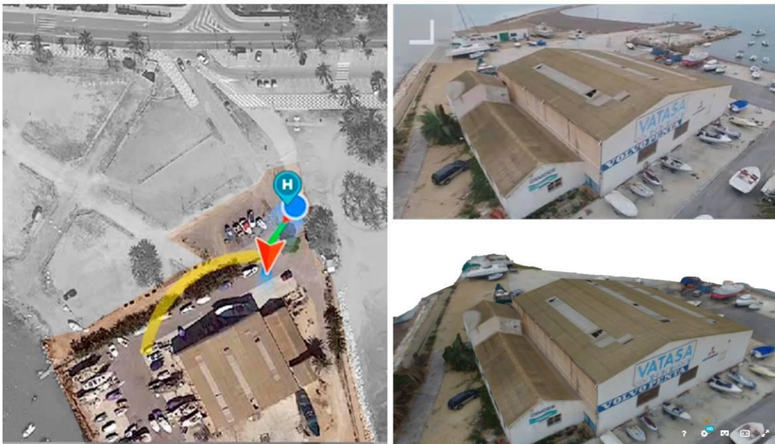
Fig. 3. Recorrido de dron, fotograma de cámara y modelo tridimensional. 2017. Elaboración propia.
