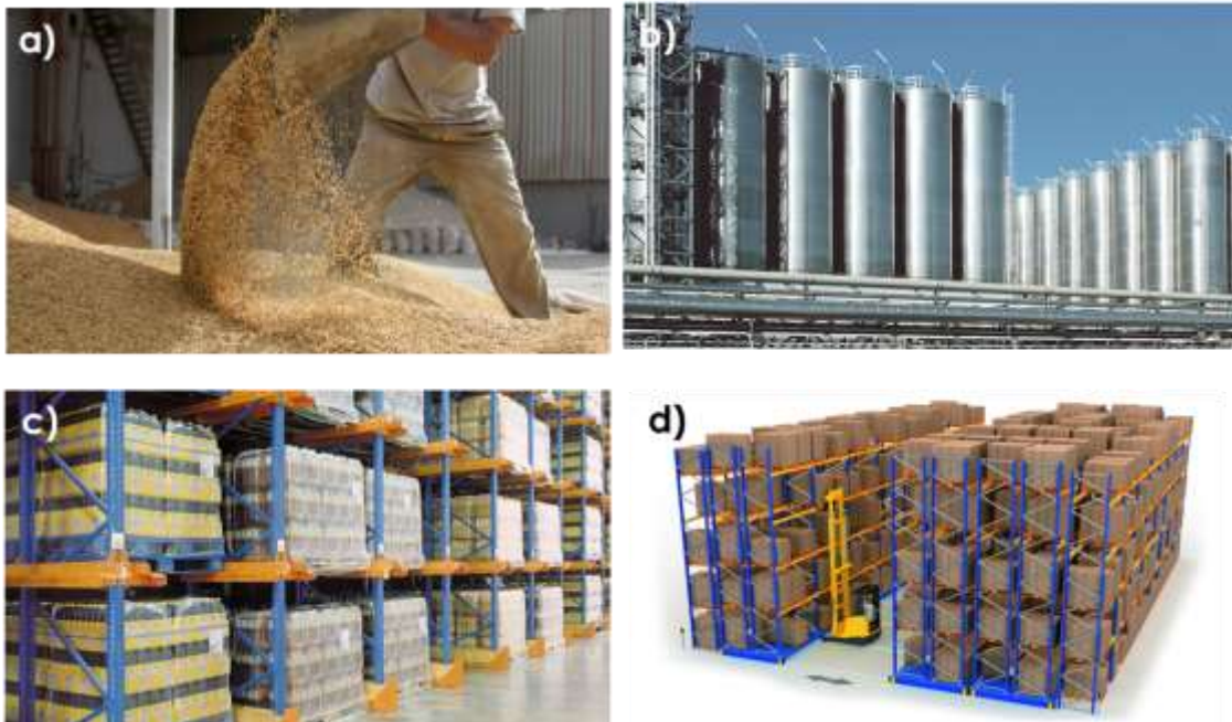
Figura 3. Tipos de almacén según el tipo de estructura de almacenaje: a granel (a), en silo (b), en estanterías fijas (c) y en estanterías móviles (d).
