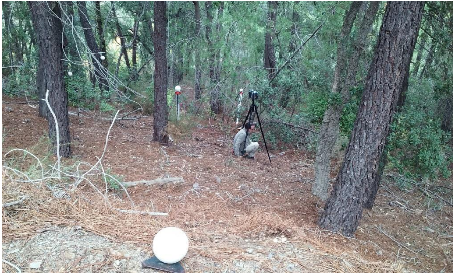
Imagen 3. Disposición de las dianas empleadas para la toma de datos en relación al posicionamiento del láser escáner
