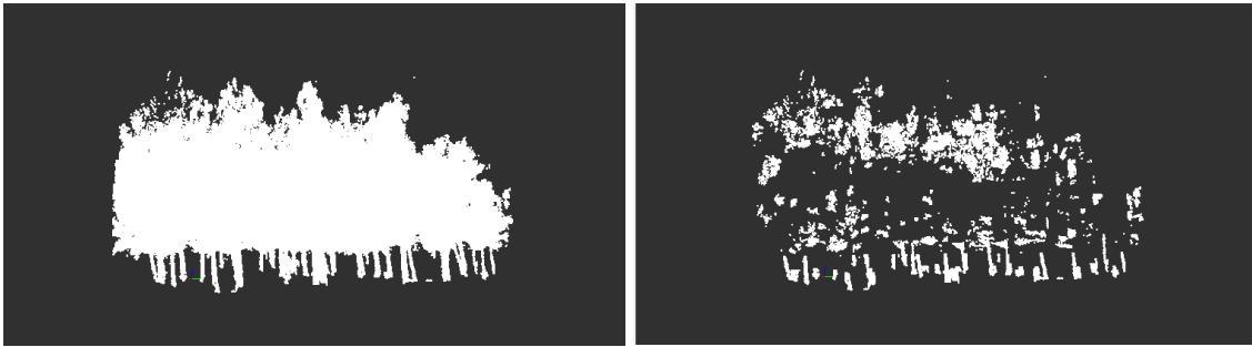
Imagen 80. Comparativa entre la nube de puntos tras el filtrado realizado, mostrando los puntos despreciados
