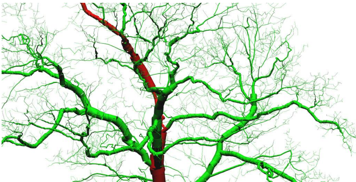
Imagen 8. Visualización del modelado QSM generado a partir de una nube de puntos.
