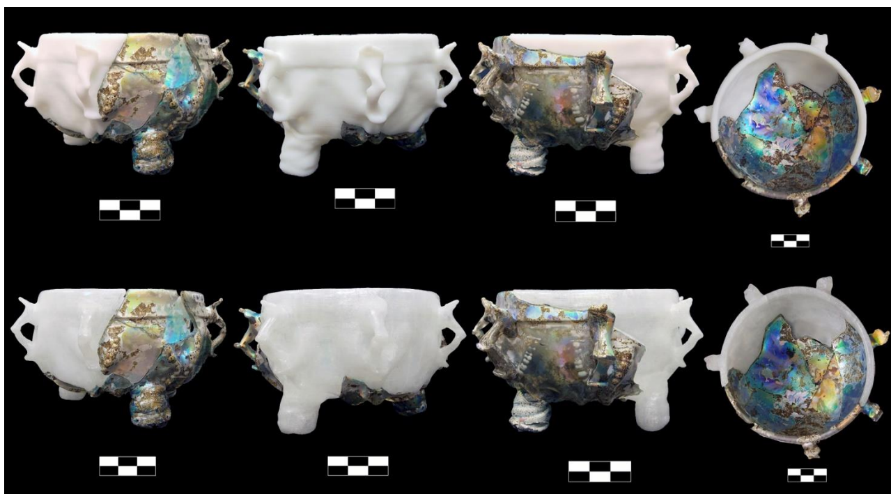
Figura 6. Resultado final de las impresiones 3D con filamento blanco (arriba) y translúcido (abajo).
