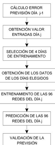
Figura 8.2 Etapas del método de predicción propuesto
