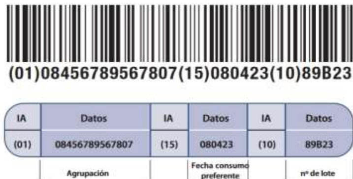
Figura 6. Esquema de un código de barras codificado por sistema GS1 128.
