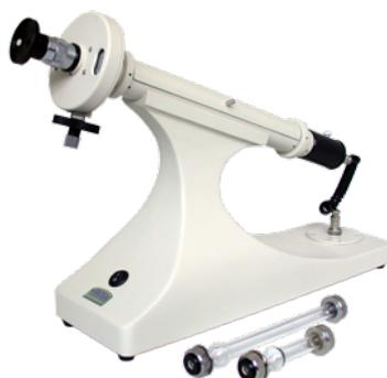
Figura 3. Polarímetro y tubos polarimétricos de medida
