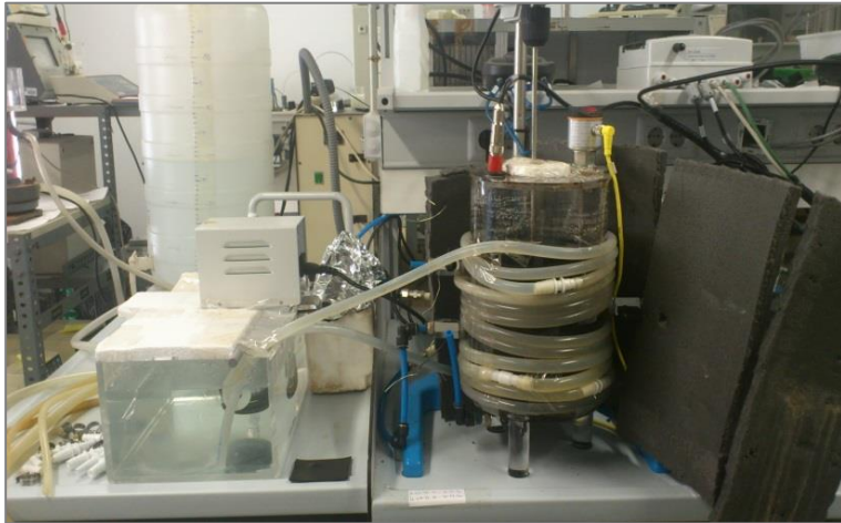
Figura V.3. Sistema calefactor externo al SBR.
