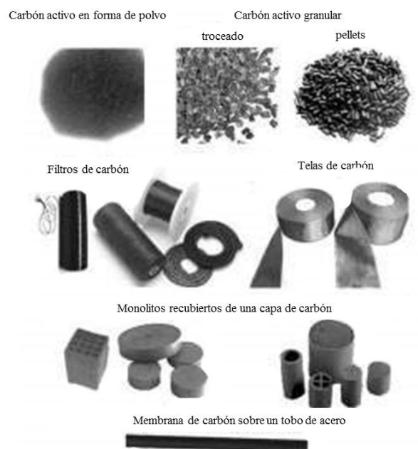
Figura III.6. Formatos del carbón activo [68].
