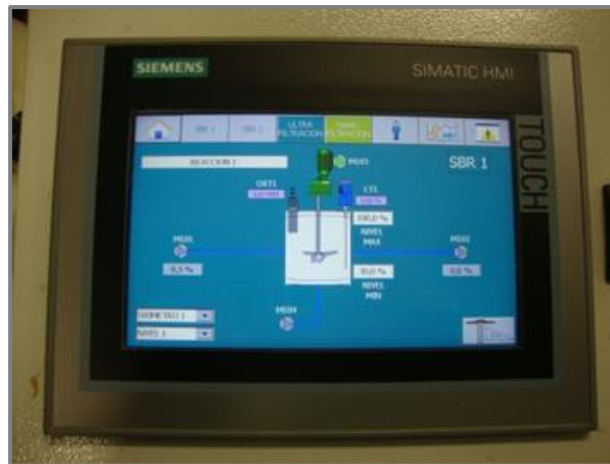
Figura IV.4. Autómata planta ITACA; interfaz informativa.
