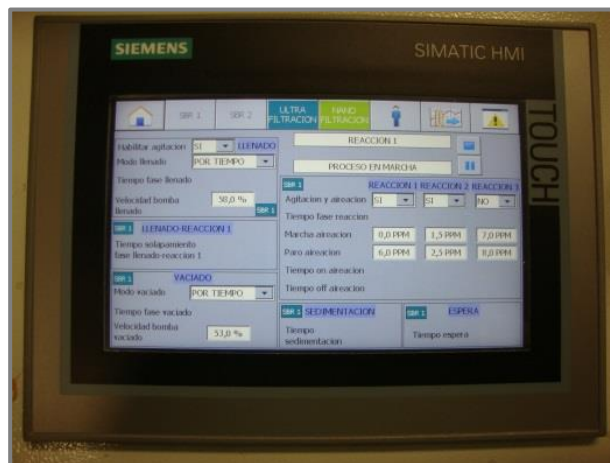
Figura IV.5. Autómata planta ITACA; interfaz modificaciones.
