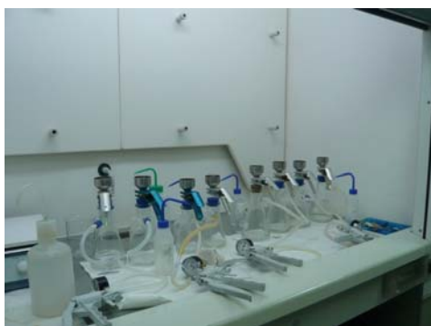
Figura 3.17: Proceso de filtración de las muestras para los recuentos fitoplanctónicos
