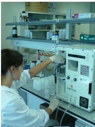
Figura 3.16: Salinómetro (conductímetro de inducción) para determinar la salinidad de las muestra
