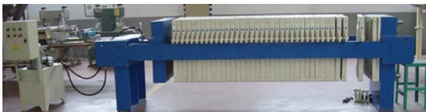
Figura 4. Ejemplo de filtro intermitente de marcos y placas (Garibay, 2014)
