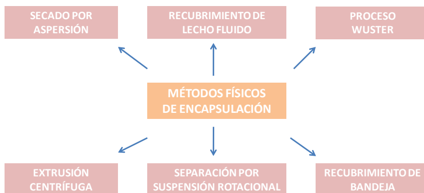
Figura II-23. Esquema de procesos físicos de encapsulación.
