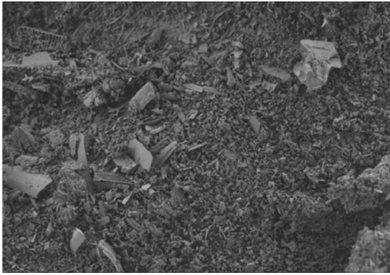
Ilustración 26: Tierra de diatomea JJ a) Microscopia a 500 aumentos; b) Microscopia a 2000 aumentos
