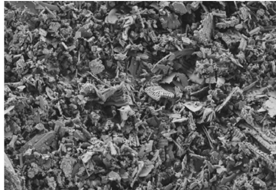
Ilustración 26: Tierra de diatomea JJ a) Microscopia a 500 aumentos; b) Microscopia a 2000 aumentos
