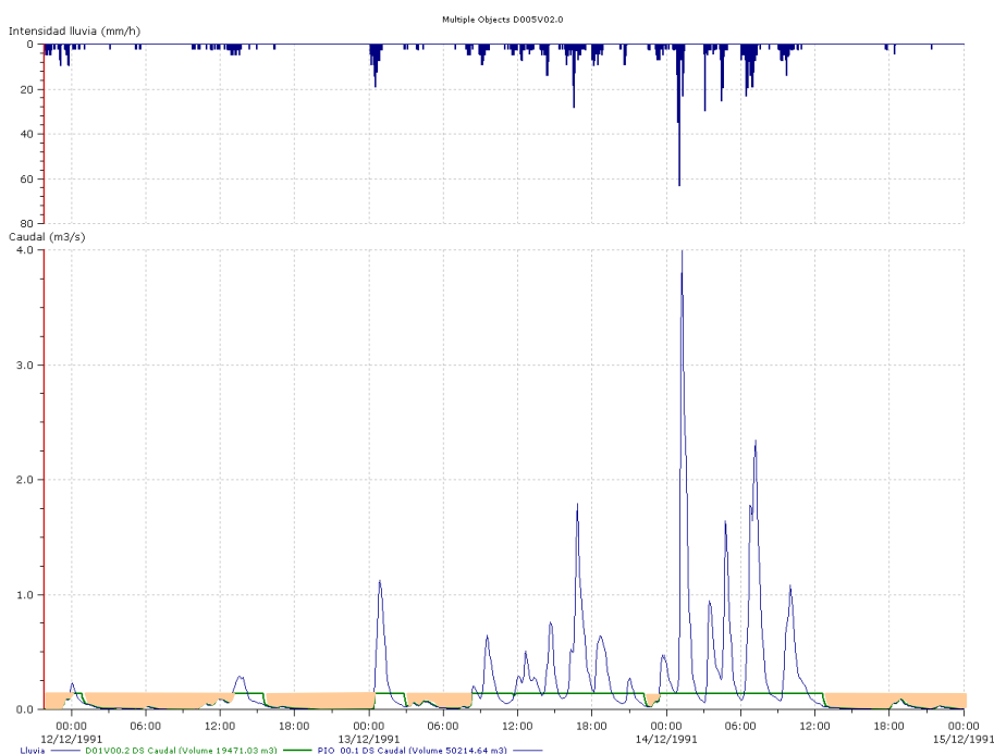
Figura IV.22. Simulación del evento EV088 con V_D=5 \text{ m}^3/\text{ha} y Q_V=2\text{l/s/ha} .
