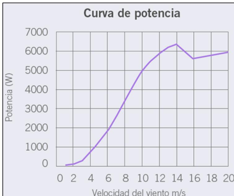
**Figura 30.** Curva de potencia aerogenerador BORNAY 6000
