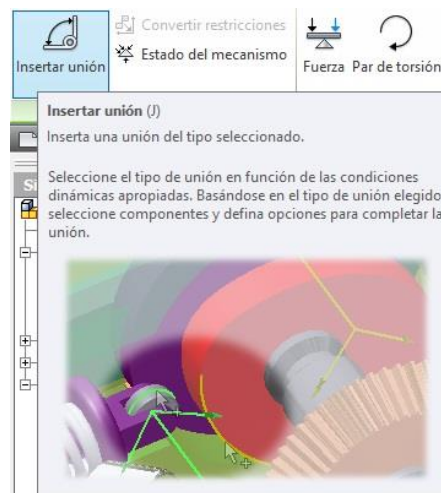
FIGURA 17. DETALLE INSERTAR UNIONES
