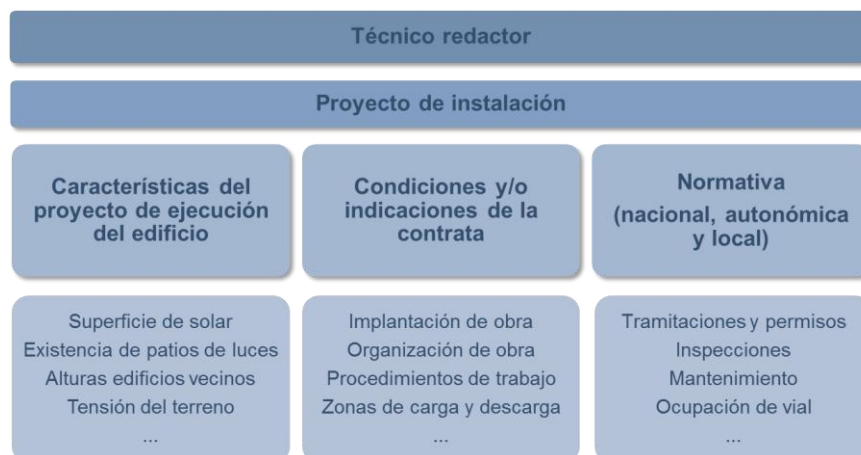
Gráfico 3. Agentes intervinientes en la instalación y puesta en servicio de una grúa torre
