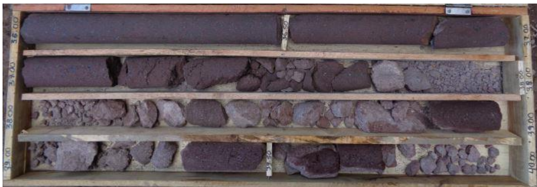
Fotografía 25. Vista de escoria de composición andesítica. Sondeo PTB-01.
