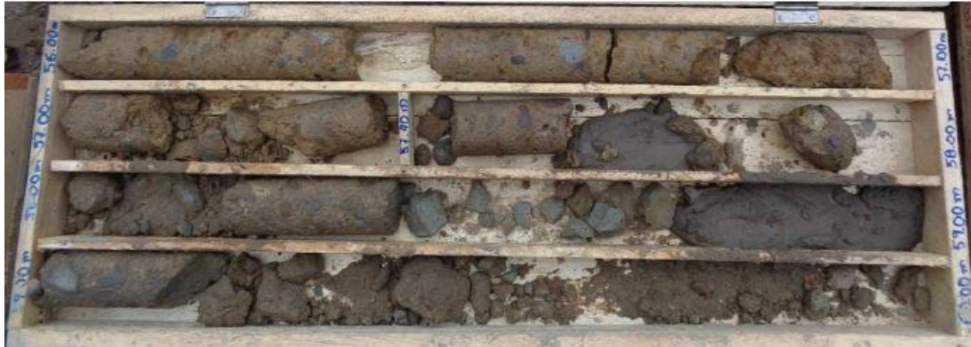
Fotografía 21. Vista de la toba brechosa. Sondeo PTB-04.
