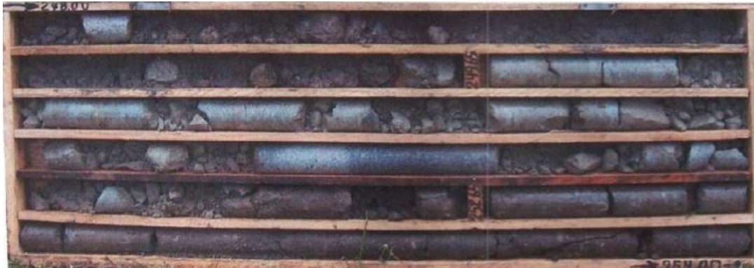
Fotografía 24. Vista de lahar. Sondeo PTB-02.
