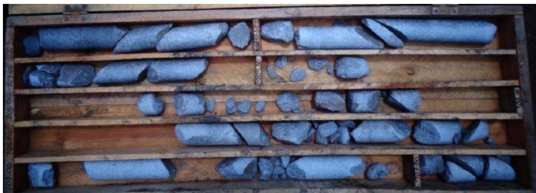
Fotografía 22. Vista de la andesita fracturada. Sondeo PTB-05.
