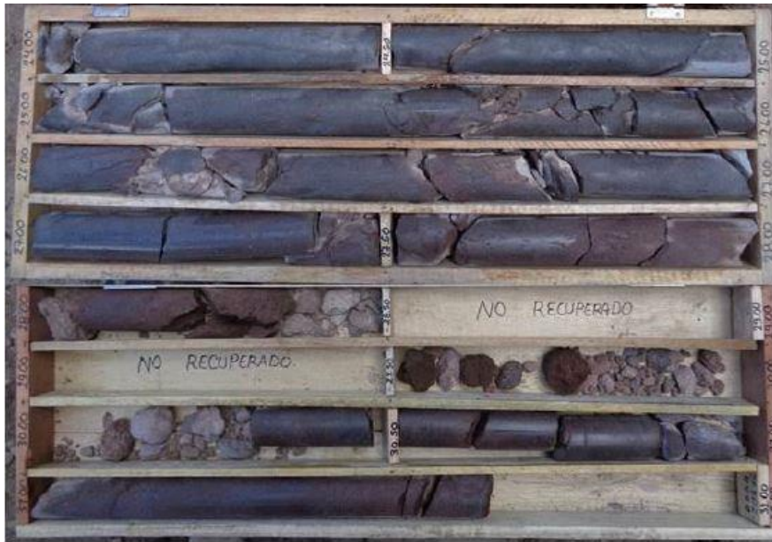
Fotografía 26. Vista de la zona de cizalla. Sondeo PTB-01.
