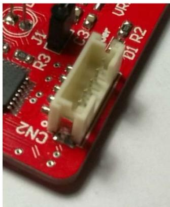
**Figura 7 Puerto de programación del controlador**
