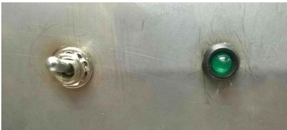
**Figura 6 Interruptor de alimentación de la panelera**
