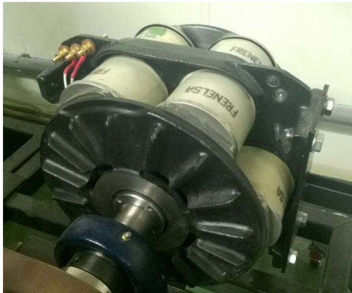
Figura 1 Freno dinamométrico
