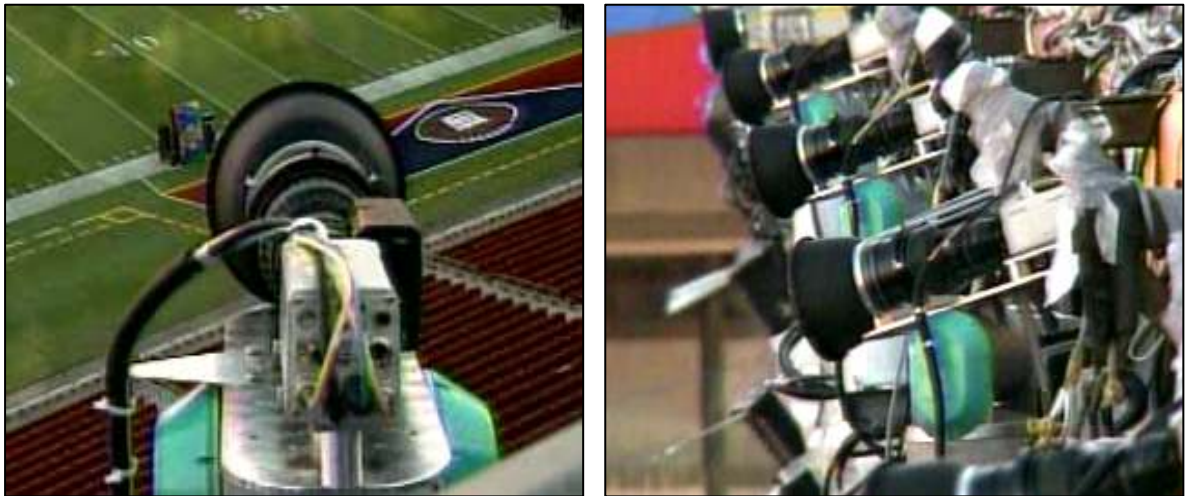
Cámara-maestra trasladando sus parámetros de posición y movimientos a las cámaras esclavas del sistema Eye Vision
