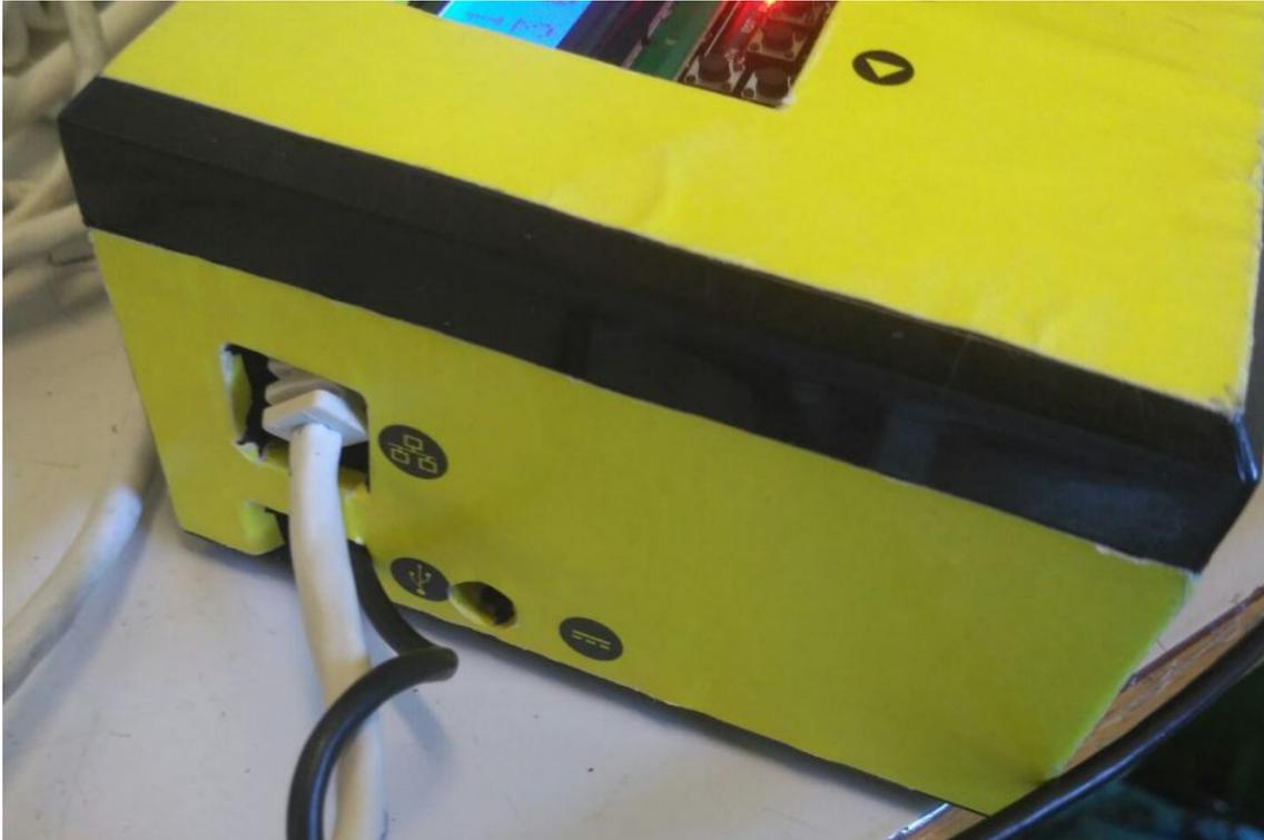
Figura 5.4: Conexiones de comunicación y alimentación del analizador
