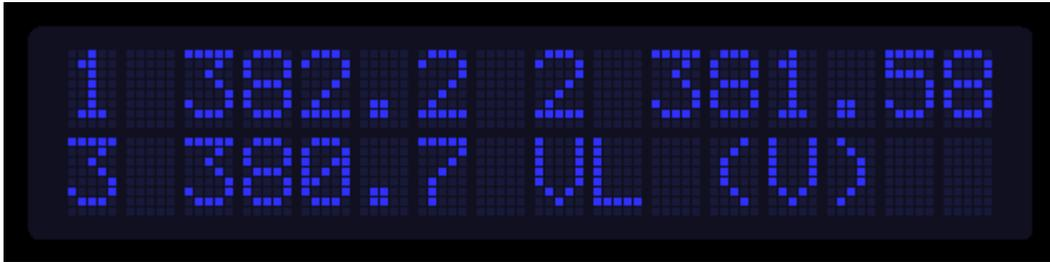
*Figura 2.6: Diseño de la pantalla del analizador*
