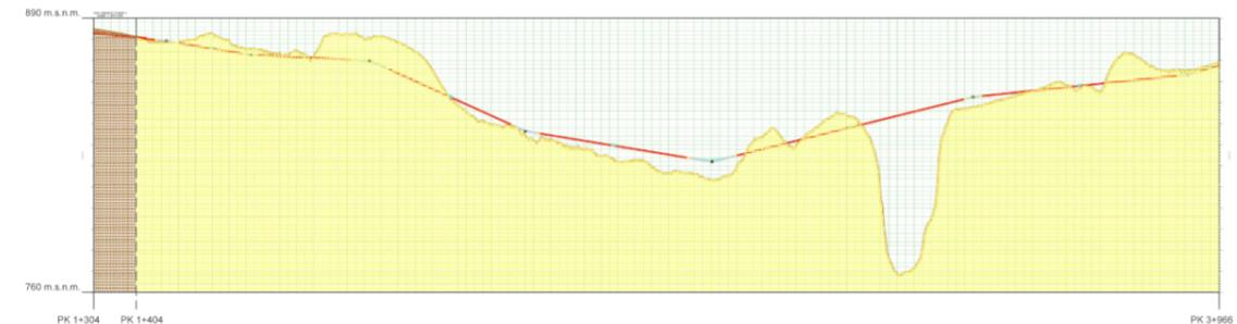
Figura 3: Perfil longitudinal Alternativa 2 con materiales por punto kilométrico.
