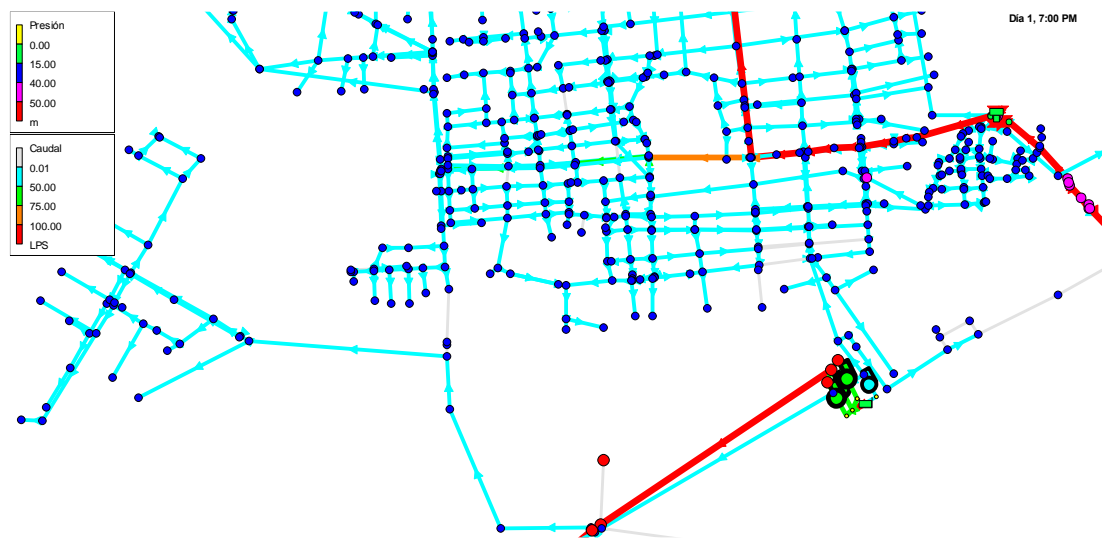
Figura 60. Presiones en la zona Sur I tras la introducción del variador
