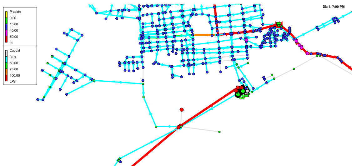
Figura 56. Problemas de presión tras parar bomba 1
