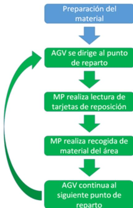
*Ilustración 18. Flujograma del nuevo proceso de reposición de material*
