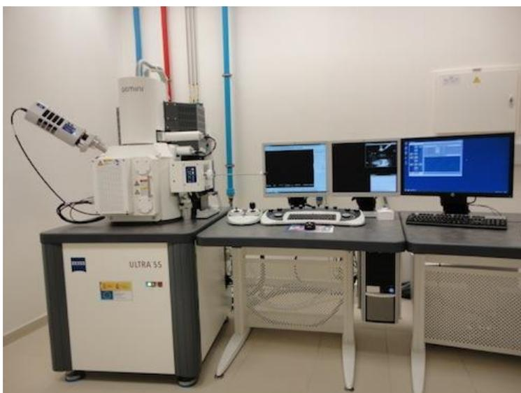
*Figura 6. Microscopio electrónico de barrido de emisión de campo (FESEM) utilizado para la caracterización de las muestras de catalizador.*
