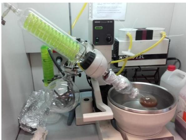
Figura 2. Montaje del Rotavapor r 114 BÜCHI
