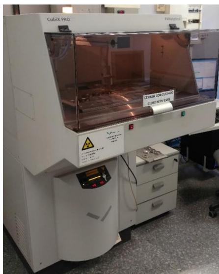
Figura 5. Difractómetro Cubix PRO de PANalytical
