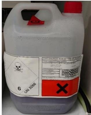
*Figura 9. Bidón correspondiente al grupo 6 de residuos peligrosos con su correspondiente etiquetado.*
