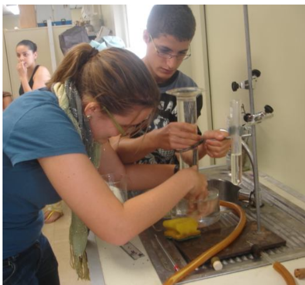
Imagen 8.9.-Alumnos montando un dispositivo para recoger hidrógeno sobre agua.
