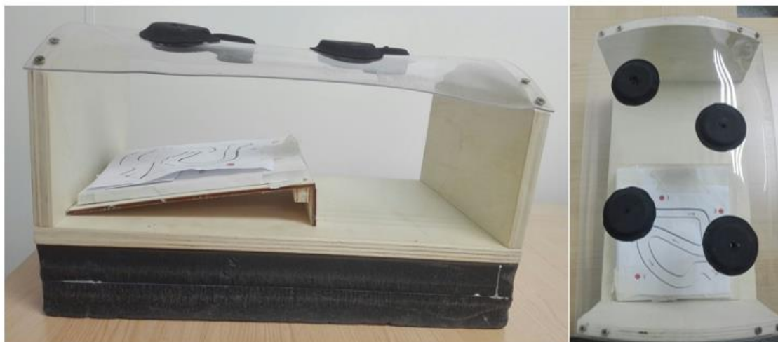
Figura 12. Caja con entradas en forma de agujero revestido para dificultar el movimiento que simula la cavidad abdominal en una intervención laparoscópica.
