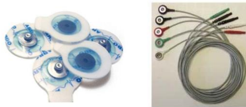
Figura 14. Electrodo Ag/Cl a la izquierda, cables y conectores botón a la derecha.
