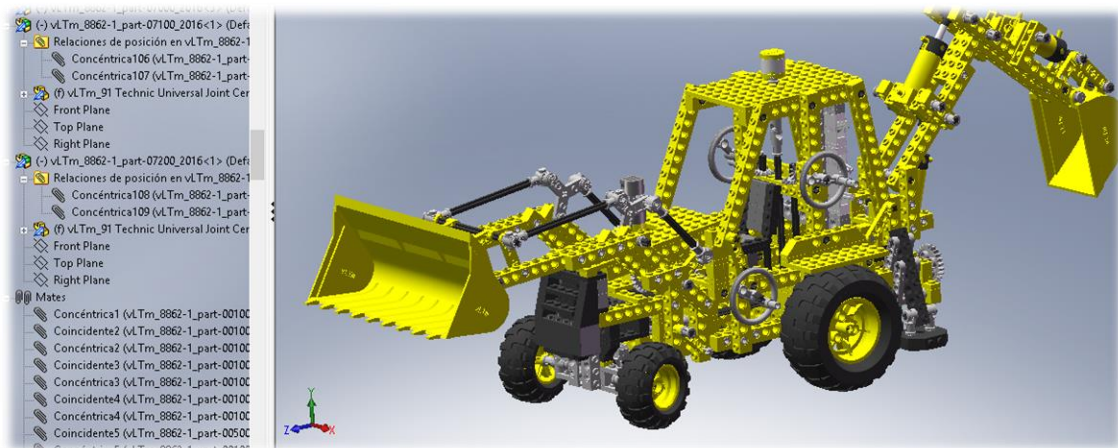
Fig. 12 Árbol de restricciones en SolidWorks 2007
