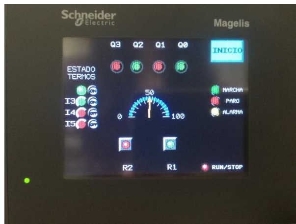
Ilustración 50: Implementación del programa en las pantallas diseñadas: pilotos Q0, R1 y Q2 activadas
