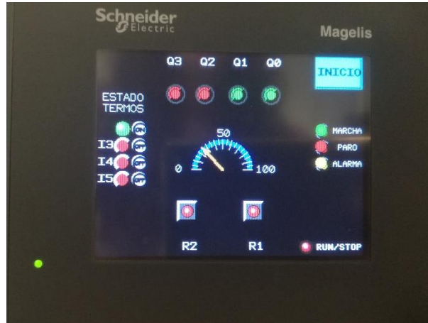
Ilustración 47: Implementación del programa en las pantallas diseñadas: pilotos Q0 y Q1 activadas
