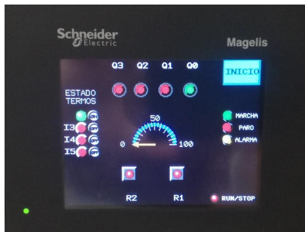
Ilustración 45: Implementación del programa en las pantallas diseñadas: piloto Q0 activado
