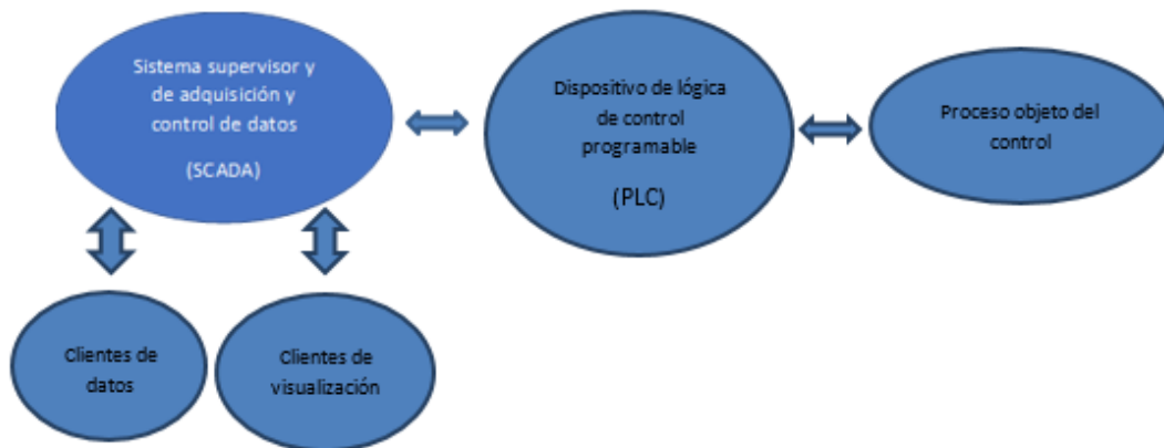
Ilustración 7: Partes de un sistema SCADA conectado a un proceso automatizado.
