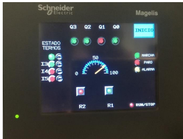
Ilustración 51: Implementación del programa en las pantallas diseñadas: pilotos Q0, R1, Q2 y Q3 activadas
