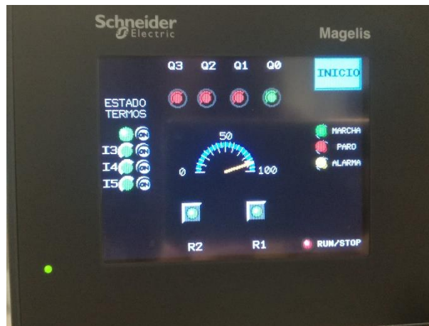
Ilustración 53: Implementación del programa en las pantallas diseñadas: pilotos Q0, R1 y R2 activadas
