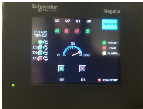
Ilustración 52: Implementación del programa en las pantallas diseñadas: pilotos Q0, R2 y Q3 activadas
