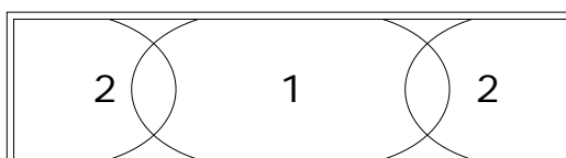
Figura 3.23. Secuencia de llenado del molde (UNE-EN 14651:2007 + A1:2008).
