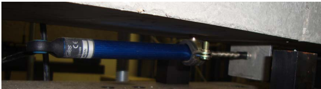
Figura 3.11. Transductor de desplazamiento emplazado en la probeta.
