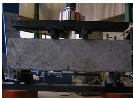
Figura 5.4. Montaje de ensayo a flexotracción empleado en el estudio.
