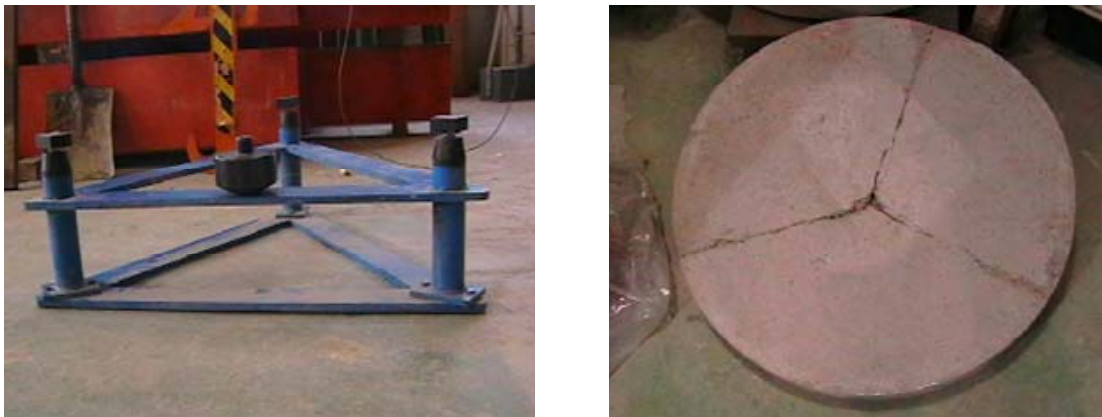
Figura 2.17. ASTM C 1550, soporte (izq.) y disco ensayado (der.).
