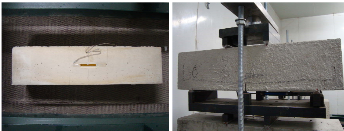
Figura 3.9. Probeta instrumentada, con banda extensométrica en cara superior (izquierda) y transductor de desplazamiento en cara inferior (derecha).
