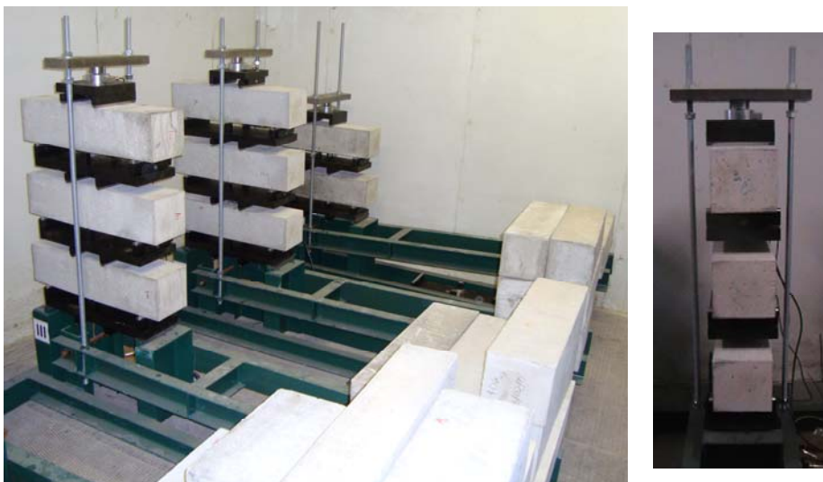
Figura 3.4. Bastidores en funcionamiento (vista general y detalle de columna de probetas).
