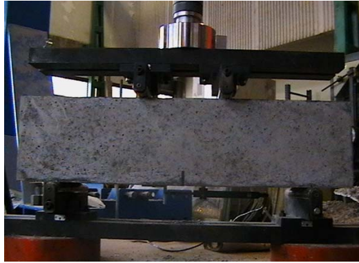
Figura 3.26. Montaje de ensayo a flexotracción empleado en el estudio.
