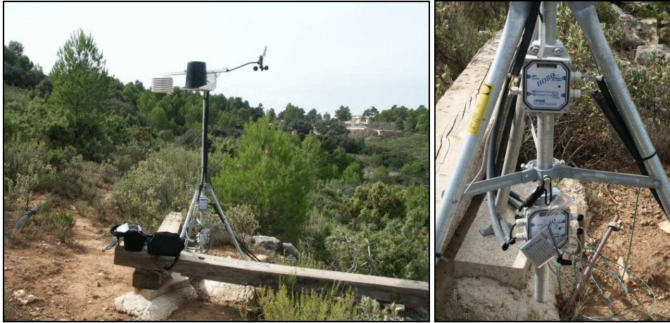
Figura 11. Vista de la estación meteorológica con un detalle a la derecha de los data-logger donde se almacenan los datos (cada 5 minutos) medidos por los sensores de temperatura y humedad del suelo, radiación, precipitación y dirección y velocidad del viento. La temperatura y humedad del aire se registran en un data-logger incorporado al sensor situado dentro del protector de la radiación directa.
