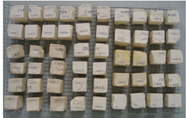
Figura 9. Probetas tras 2h de baño en solución salina.
