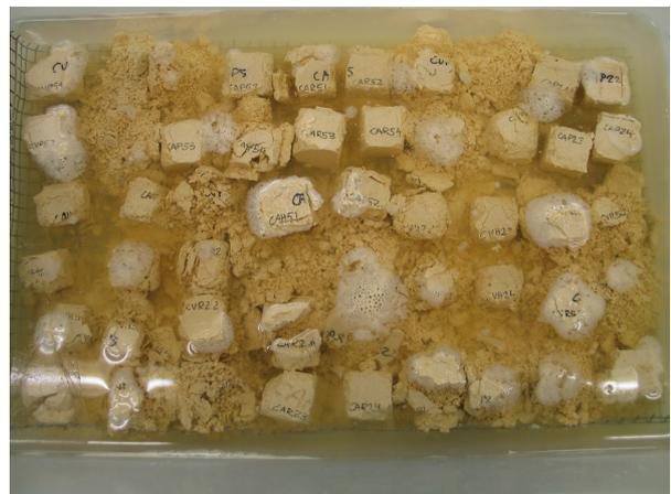
Las probetas de este grupo 2013, se desintegran ya en el primer baño salino. Aún así, se introdujeron en estufa caliente para completar un ciclo, aunque fue imposible determinar después su peso dado el grado de desintegración y la imposibilidad de manipularlas (Figura 4).
