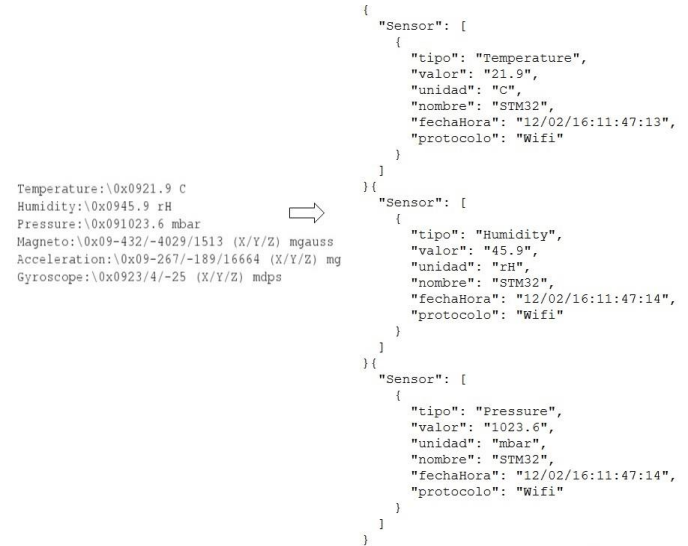
Figura 2. Transformación de los datos provenientes del sensor de ambiente y de movimiento STM32 al formato de datos JSON.
