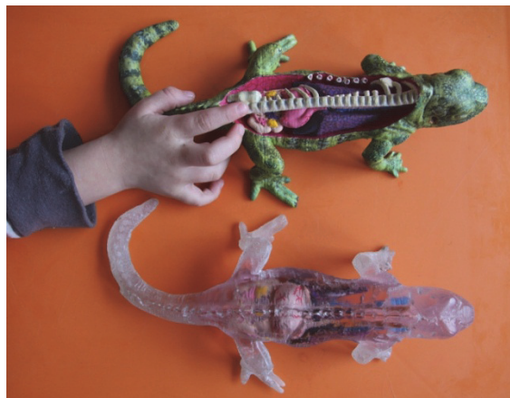
Fig. 10. Modelos impresos con tecnología FDM, esculpidos digitalmente, pintados a mano y reproducidos a través de moldes de silicona, estudiante dirigido Santiago Ramírez.
