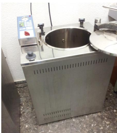
**Ilustración 15. Equipo de esterilización. Autoclave.**
