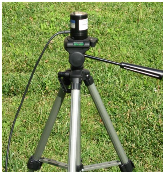
Figura 4.4.- Radiómetro PMA2102C empleado en las medidas de irradiancia eritemática
