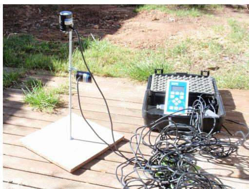
Figura 4.14.- Equipo empleado para la medida de la irradiancia UVER
