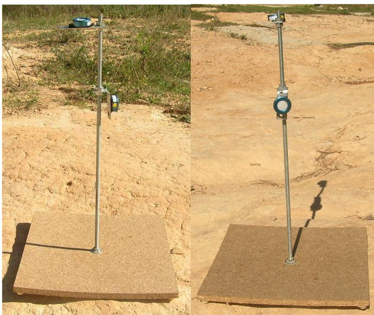
Figura 4.11.- Soporte empleado para la colocación de los dosímetros
