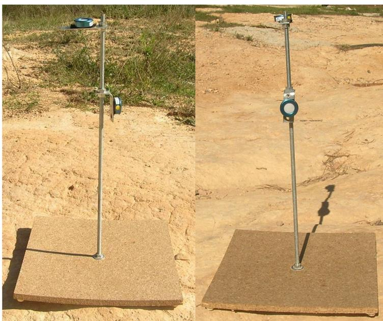
Figura 4.18.- Soporte utilizado para la colocación de los dosímetros
