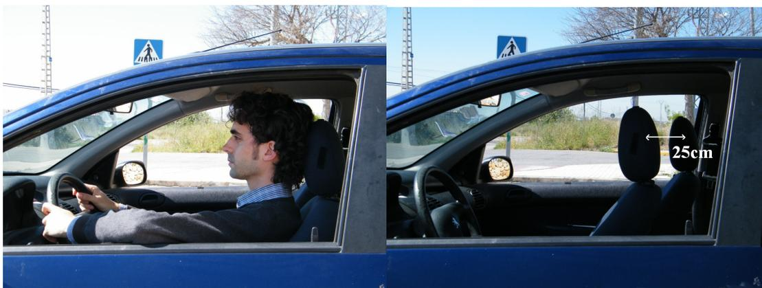
Figura 4.27.- Desplazamiento del asiento para simular la zona ocupada por una persona
