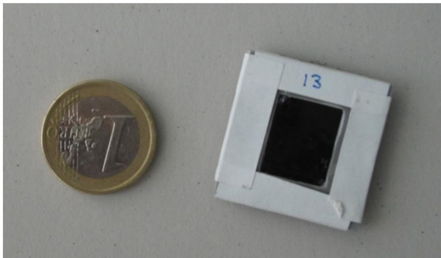
Figura 2.20.- Dosímetro de polisulfona
