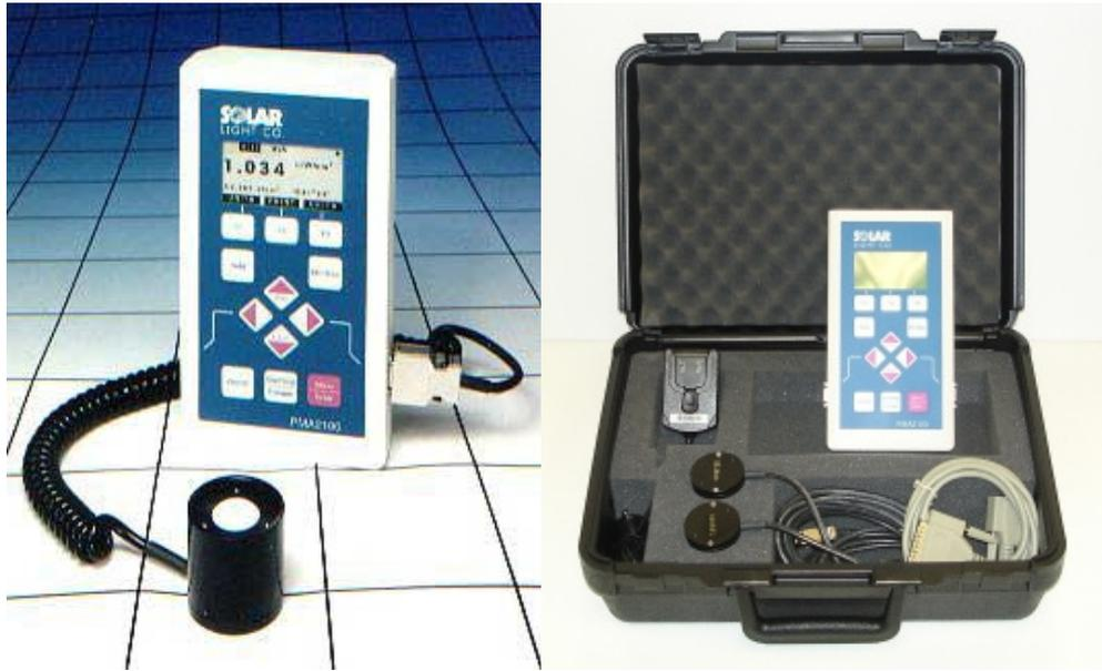
Figura 4.6.- Radiómetro PMA2100 conectado a los sensores PMA2102C empleados y a la unidad de adquisición de datos.
