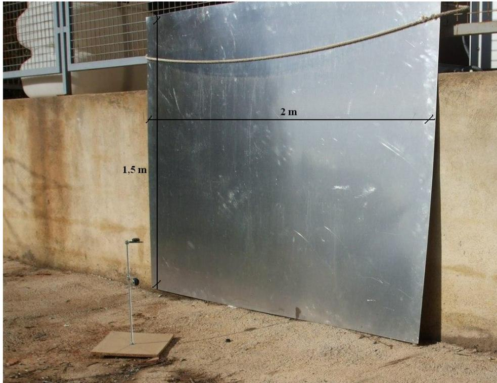
Figura 4.16.- Dimensiones y disposición del muro de metal
