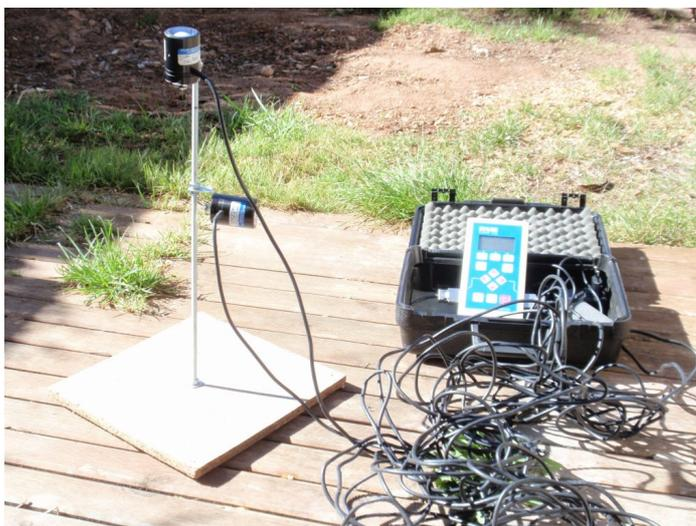
Figura 4.23.- Equipo de medida empleado para la medida de la irradiancia frente a los muros
