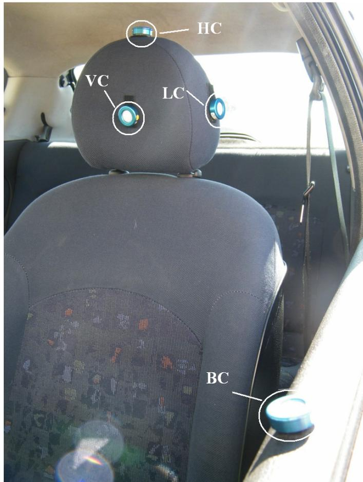
Figura 4.28.- Disposición de los dosímetros del conductor
