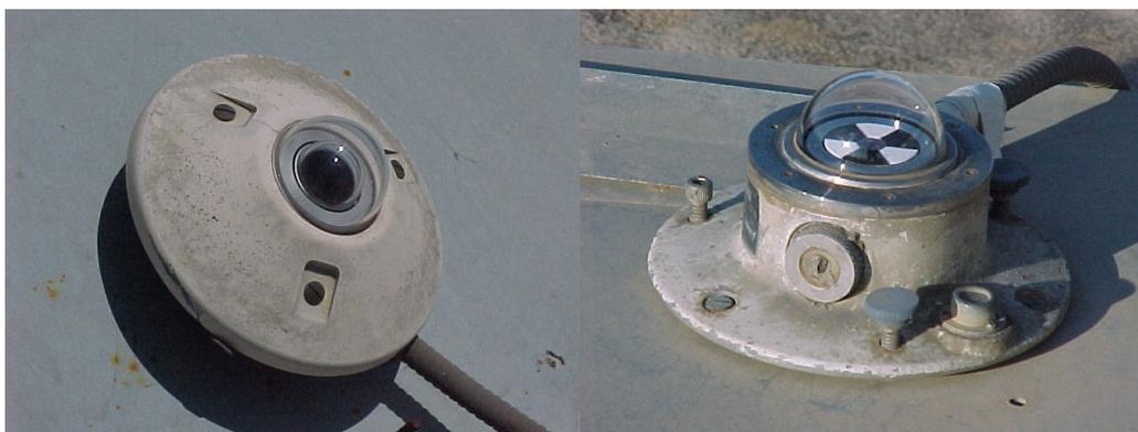
Figura 2.18.- Piranómetro para plano inclinado (izqda) y piranómetro blanco-negro (dcha)
