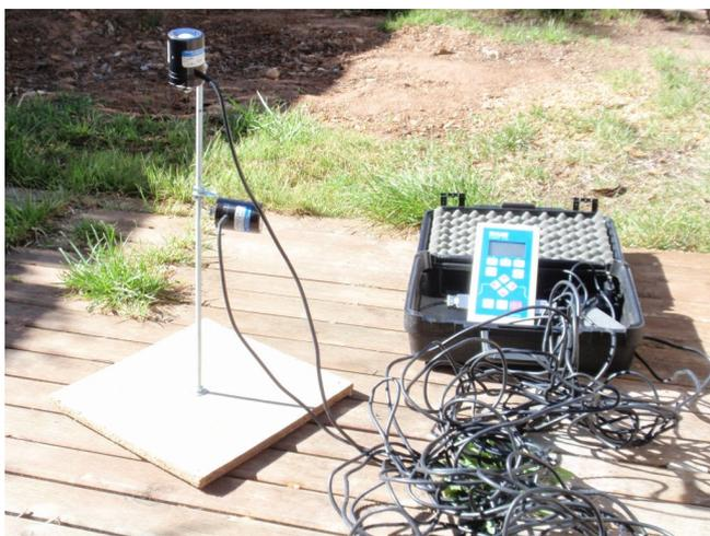
Figura 4.32.- Equipo de medida empleado para la medida de la irradiancia en el vehículo
