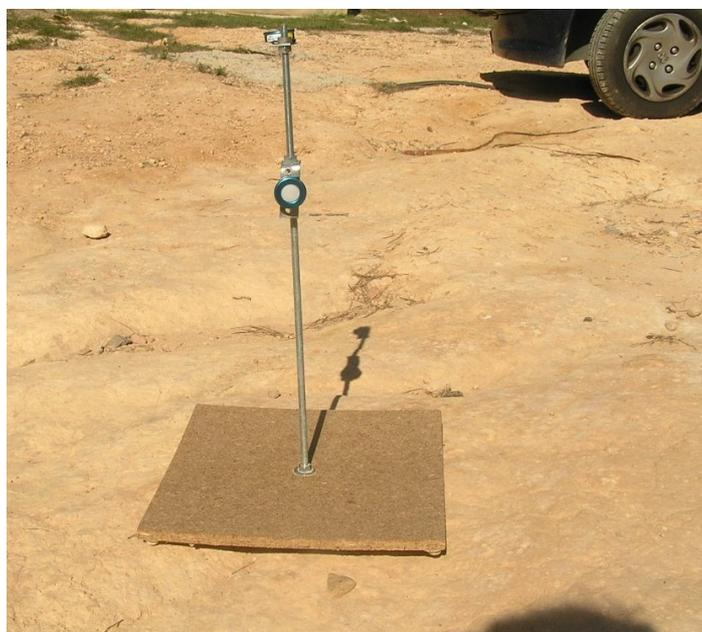
Figura 4.30.- Soporte utilizado para la colocación de los dosímetros al exterior del vehículo
