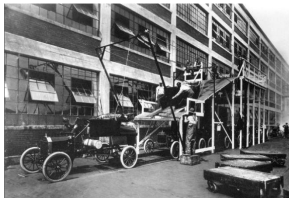
Figura 2. Ensayos de ensamble con el modelo T (1913).
