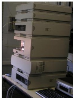
Figura 3.13. Cromatógrafo (HPLC) utilizado en la determinación de nucleótidos, nucleósidos y aminoácidos.
