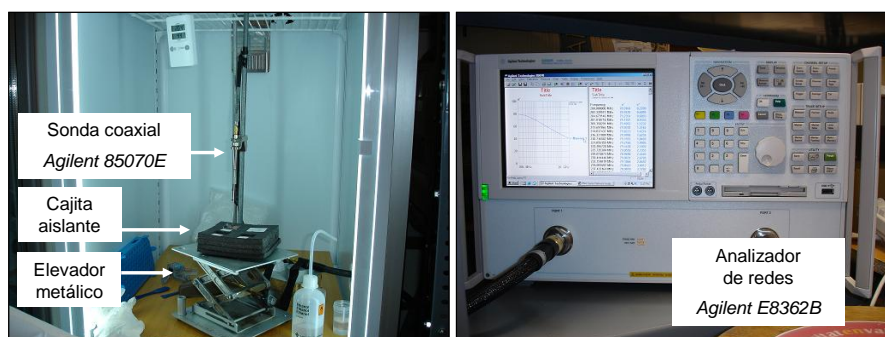
Figura 3.1. Sonda coaxial Agilent 85070E y analizador de redes Agilent E8362B .
