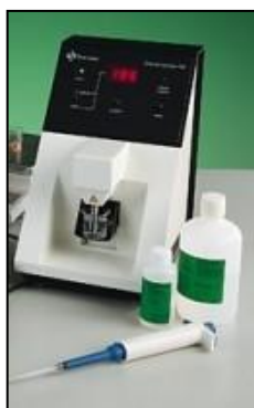
Figura 3.8. Analizador de cloruros, Sherwood 926 Chloride Analyser
