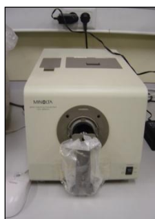
Figura. 3.12. Colorímetro Minolta CM-3600D
