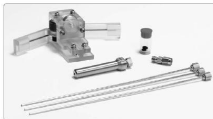
Figura 3.3. Kit para el montaje y calibración de la sonda coaxial Slim Form Probe Agilent E85070 (Agilent Technologies, 2005b).
