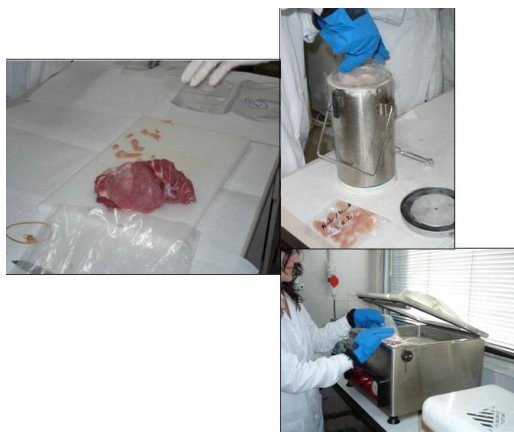
Figura 3.18. Congelación de muestras con nitrógeno líquido y envasado a vacío.
