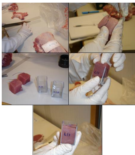
Figura 3.19. Detalle de las muestras de carne utilizadas para las medidas de espectros dieléctricos mediante la sonda coaxial Agilent 85070 , identificación de la dirección de las fibras e introducción de los mismos en los cubos de metacrilato.
