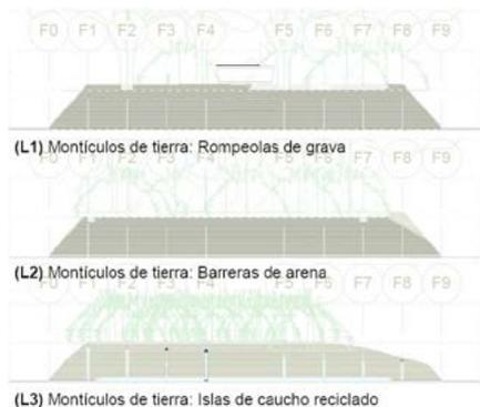
Fig. 4. Secciones longitudinales de montículos de defensa costera (2015)
