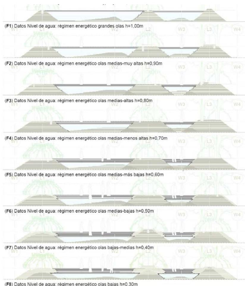
Fig. 7. Secciones transversales y paredes de niveles de agua (2015)
