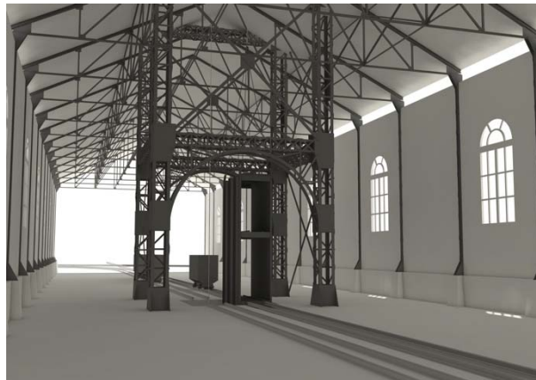
Figura 7: Interior de la nave de vaciado y llenado con base del castillete.
