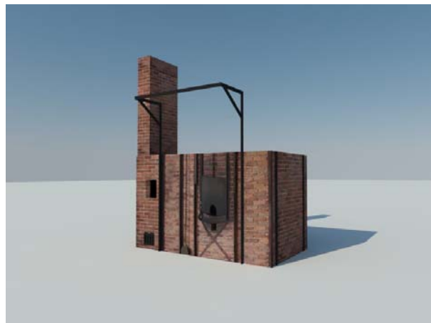
Figura 8: Pequeño horno de siderurgia en las instalaciones anexas
