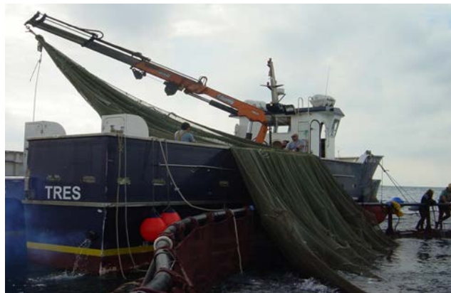
Figura 16. Cambio de una red de 25 m colmatada.
