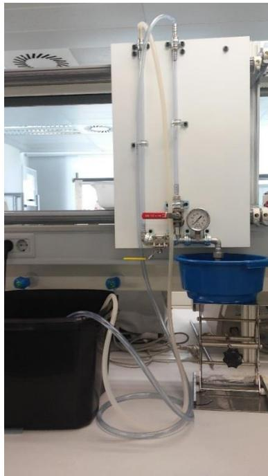
**Ilustración 8. Montaje del ensayo de permeabilidad**
