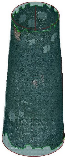
Figura 2: Mejor ajuste de la superficie exterior con un cono. GLOBAL GEOMÁTICA
