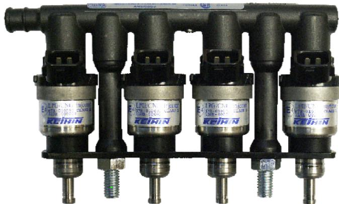
**Figura 26: Inyectores para GLP**
