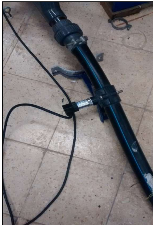
Fotografía III Transductor de presión
